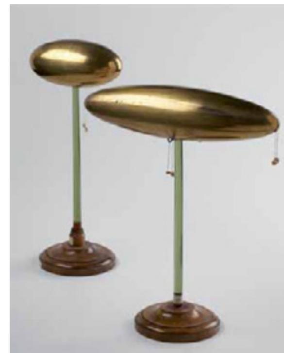
un'asta in vetro che si immerge nell'acido solforico contenuto in un'ampolla. L'acido, assorbendo l'umidità dell'asta, riduce sensibilmente la dispersione delle cariche elettriche.
