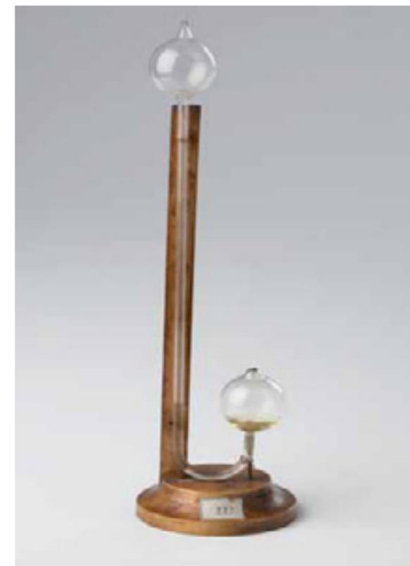
diversa e terminanti con due ampole in vetro. La base del tubo contiene etere, che riempie anche parte dell'ampolla più bassa. Riscaldando l'aria contenuta nell'ampolla più bassa questa, dilatandosi, spinge il liquido nel ramo lungo, rendendo evidente l'aumento della temperatura in un'ampolla rispetto all'altra. Lo strumento non è provvisto di scala, quindi è di tipo dimostrativo.
