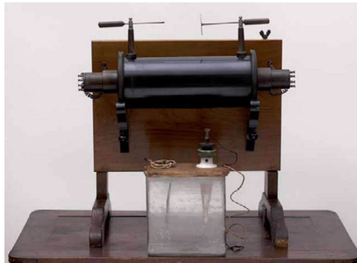
to isolante, in modo che solo la punta peschi nella soluzione. L'elettrodo di platino si ricopre rapidamente di gas, che interrompe periodicamente il circuito, in modo molto rapido, raggiungendo anche le due mila interruzioni al secondo<sup>73</sup>.
