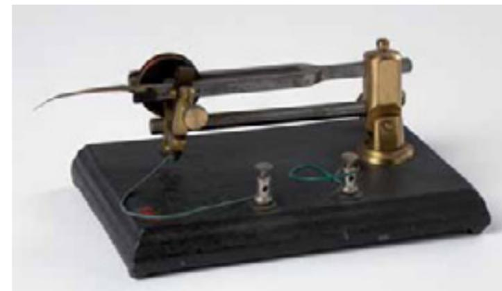
candosi dalla lamina, interrompe il passaggio di corrente. Sul diapason è incisa la nota LA. Lo strumento è usato con il vibrografo 25/A.
