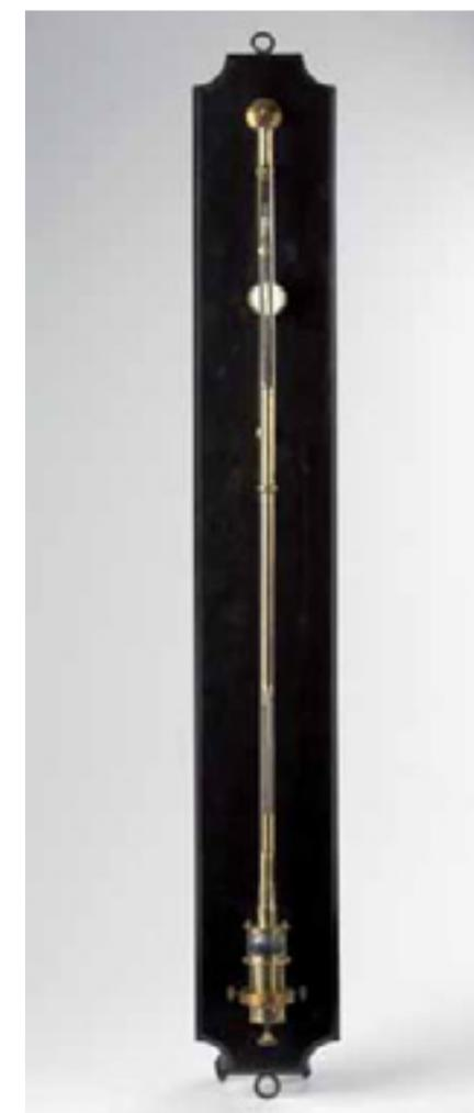
Questo barometro è appeso ad un sostegno in legno nero, sul quale è fissato un piccolo specchio rotante per la lettura del livello del mercurio; sulla parte anteriore del tubo, inoltre, è fissato un termometro con scala Celsius da  $-15^{\circ}\text{C}$  a  $+50^{\circ}\text{C}$ .
