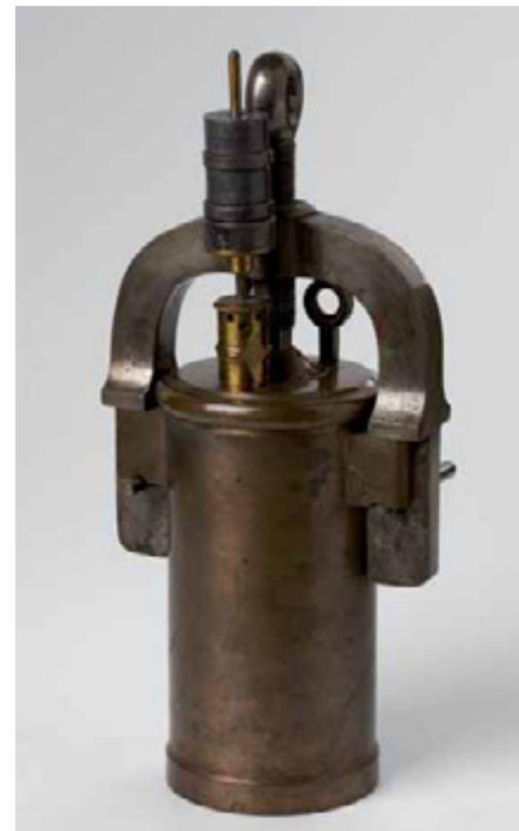
montata una valvola sovrastata da una serie di pesi in piombo, la cui funzione è quella di aumentare la pressione interna alla pentola. L'acqua contenuta nella pentola bolle ad una temperatura superiore a  $100^{\circ}\text{C}$  se è sottoposta ad una pressione superiore a una atmosfera.
