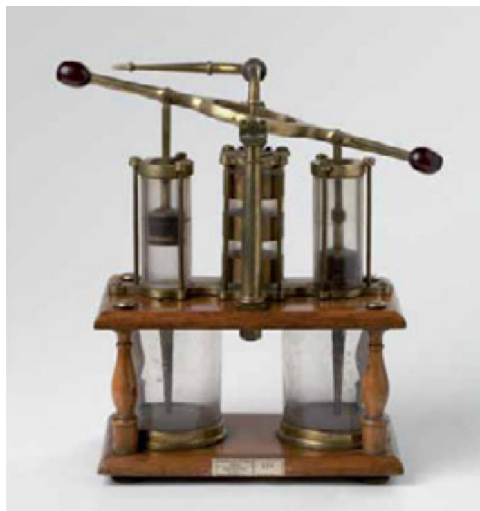
vola che si apre verso l'interno del serbatoio; da qui fuoriesce a forte velocità attraverso lo stretto tubo di erogazione, spinta anche dall'aria compressa nel serbatoio. La presenza dei due corpi di tromba, che agiscono alternativamente, e il serbatoio d'aria consentono un'erogazione costante.
