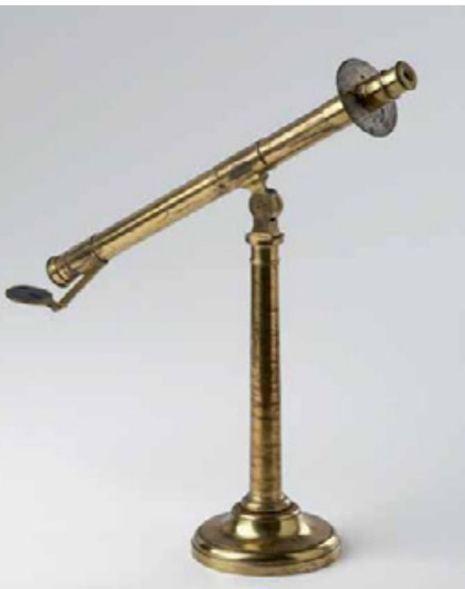
e posizione dipende dallo spessore dello strato d'aria intrappolato fra lente e disco. Tale spessore è regolato dalle tre viti poste sul telaio.
