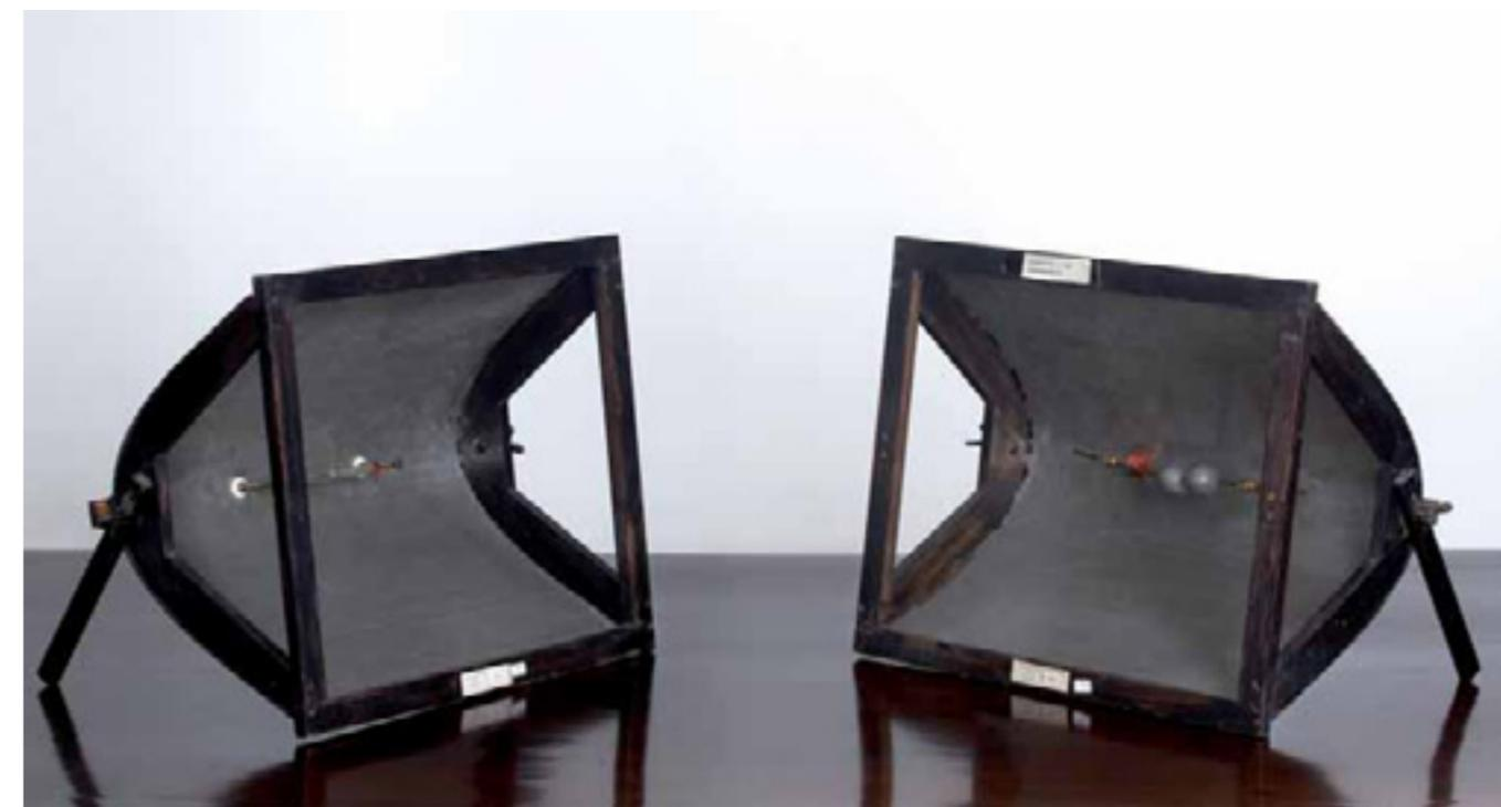
però nello spazio circostante avviene una perturbazione elettrica, come lo scoccare di una scintilla, il coherer diventa conduttore, rivelando perciò di essere stato investito da un'onda elettromagnetica.
