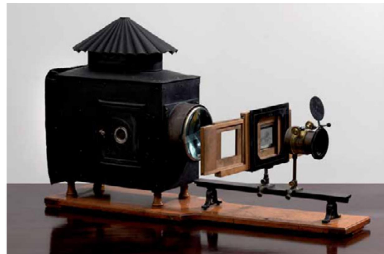
diametro. Un otturatore a fenditura regolabile può essere montato davanti al condensatore. Alla base in legno è fissato un binario metallico su cui si fissano dei morsetti di ottone per sostenere gli accessori, fra i quali vi è un obiettivo da 150 mm.
