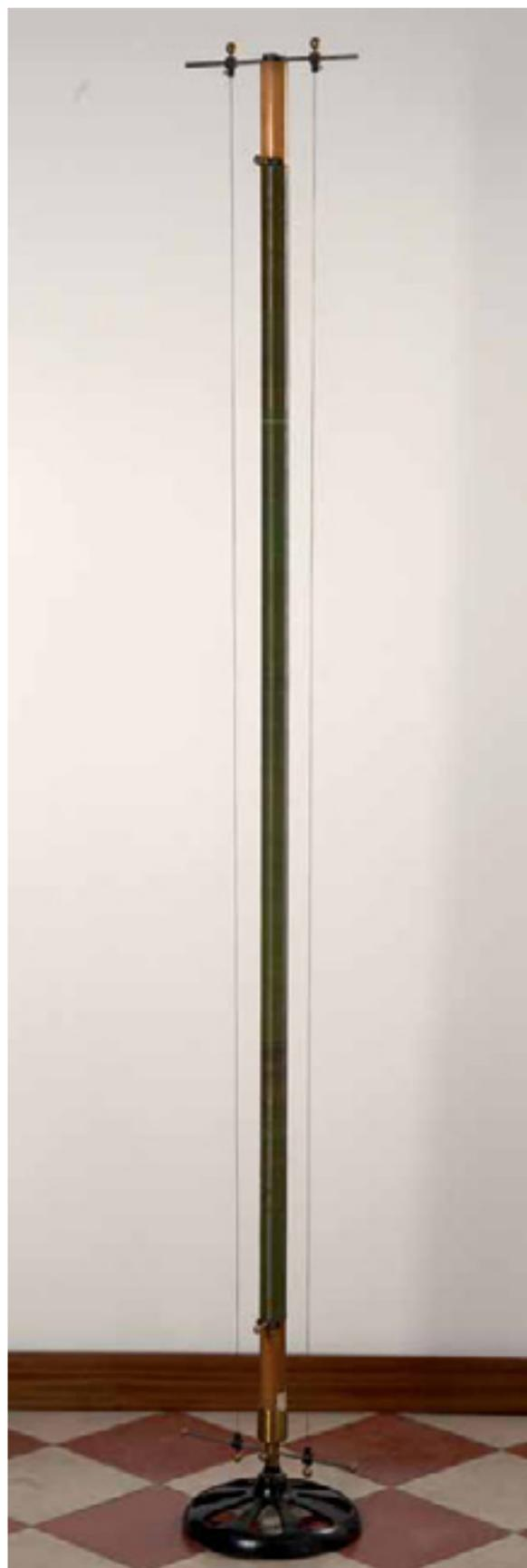
quenza prodotta nel secondario del trasformatore 142/E. In corrispondenza dei massimi di tensione (ventri) fra la bobina e i fili paralleli appaiono degli effluvi elettrici<sup>77</sup>.
