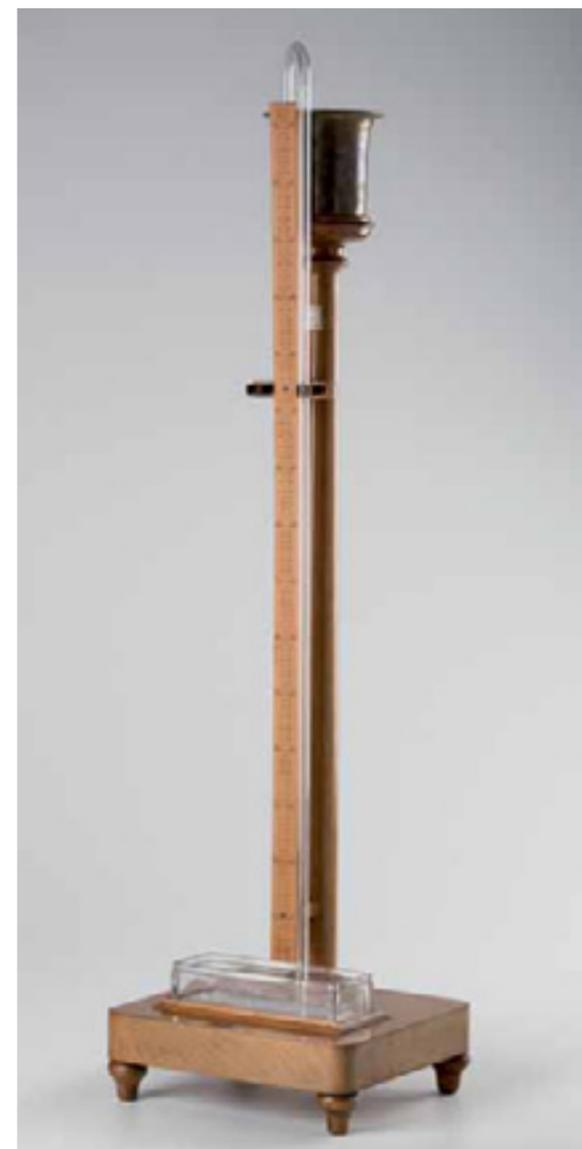
piedi torniti, sostiene una colonna che termina con una piattello rotondo nel quale si incastra un bicchiere d'ottone; anteriormente alla colonna è fissato un regolo lineare in legno diviso in centimetri.
