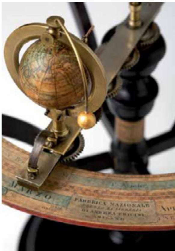
movimento di rivoluzione. Il meccanismo è posto in funzione agendo su un'asta fissata diametralmente alla piastra. Tra il Sole e la Terra si trova una colonnina d'ottone con un ago orizzontale che segna la direzione dei raggi solari.
