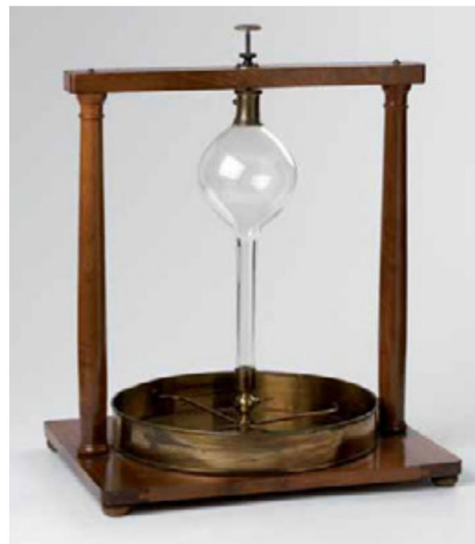
serve a verificare la legge di Torricelli<sup>9</sup>, secondo la quale la velocità di efflusso del liquido è direttamente proporzionale alla radice quadrata della differenza di pressione fra la superficie libera e il foro di efflusso<sup>10</sup>.
