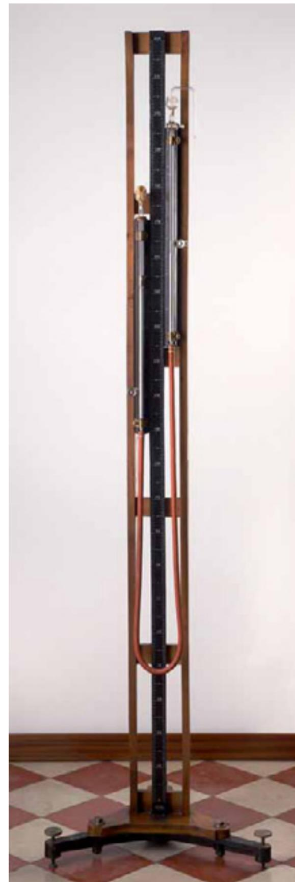
eguagliato il livello del mercurio nei due rami di vetro, in corrispondenza di un volume fissato di aria intrappolata nel ramo chiuso, si innalza il ramo aperto fino a dimezzare il volume dell'aria contenuta in quello chiuso. Sulla scala graduata si verifica che ciò avviene in corrispondenza di un innalzamento di 76 cm, corrispondente al raddoppio della pressione.
